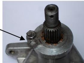
Bevor man das Spiel durch Drehen der exzentrischen Lagerbüchse der Segmentwelle verringert, sollte das **Höhenspiel der Segmentwelle** und ein **Axialspiel der Lenkschnecke** beseitigt werden.
