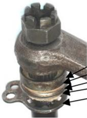
Dieser Ring hat die Aufgabe die Segmentwelle oben mit Hilfe der Dichtscheibe und den beiden Filzringen gegen das Einstellblech zu drücken und abzudichten.
